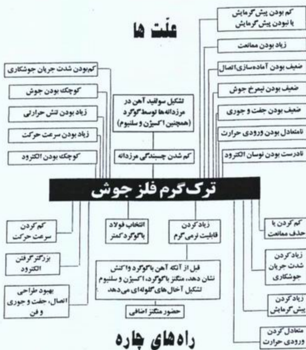
شکل (۱۳): علت‌های ایجاد ترک گرم در فلز جوش و راه‌های جلوگیری از آن
