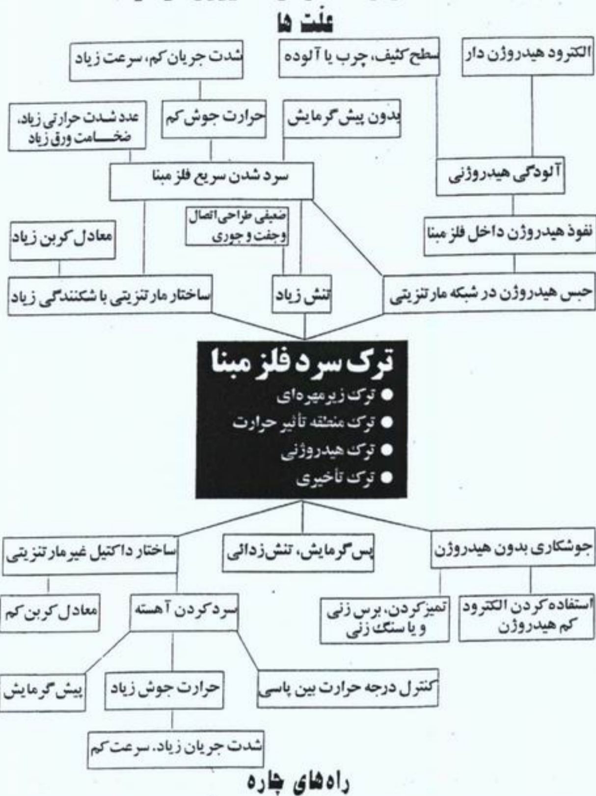
شکل (۱۶): علت های ایجاد ترک سرد در فلز پایه و راه های جلوگیری از آن
